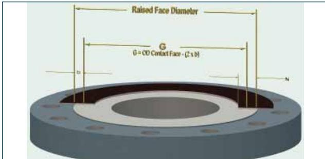
Figure 2. Bolt load parameters
